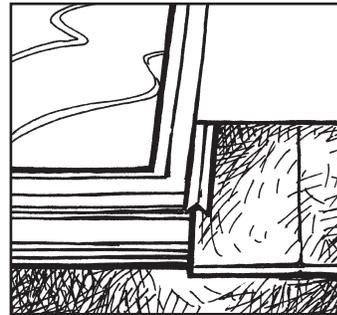
Las capas subsiguientes de papel fieltro y tablillas de madera se colocan sobre la junta en forma de "L".
