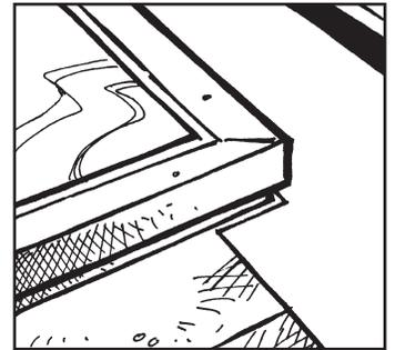
En la parte superior, el fieltro y las tablillas se colocan sobre la junta en forma de "L". Siga colocando las tablillas en el techo.
