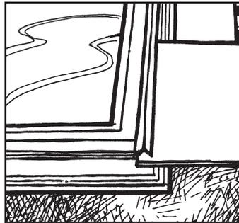
En el costado, la primera capa de fieltro, que descansa sobre la última serie de tablillas, se coloca debajo de la junta en forma de "L". La primera tablilla del costado también se coloca debajo de la junta en forma de "L".
