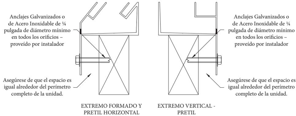
TORNILLERÍA DE ACERO INOXIDABLE SE NECESITA SI SE USA CON MADERA TRATADA A PRESIÓN
